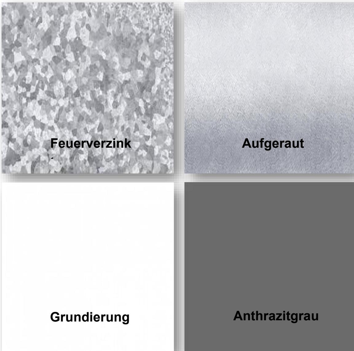
Abbildung 36: Lackierungsstufen [38] [39] [40] [42]
